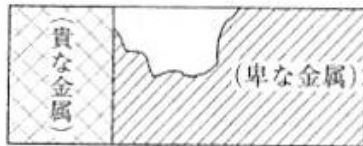
図 1-2 異種金属接触腐食
